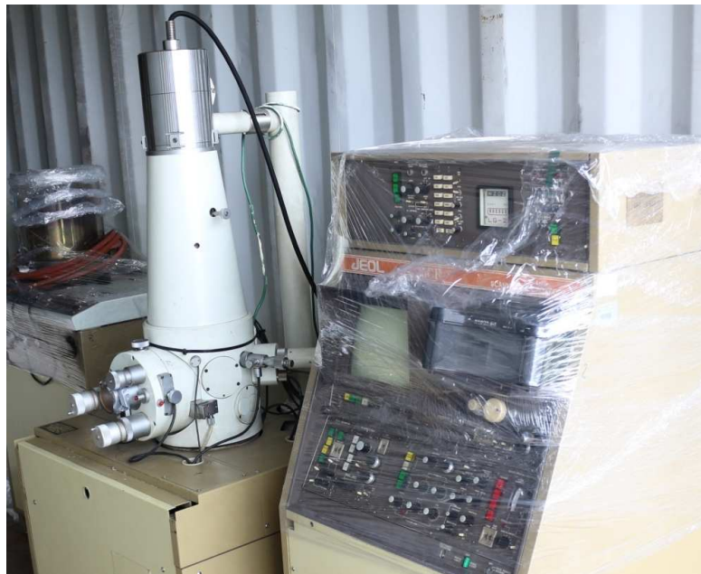
Skaningowy Japoński mikroskop elektronowy JEOL JSM-35CF w Rzepienniku.
