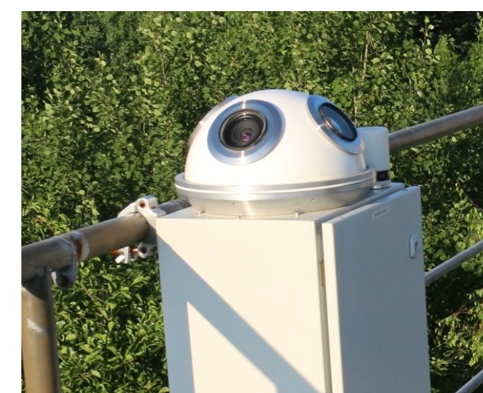
Cztery kamery szerokokątne dla obserwacji satelitów i meteorów.
