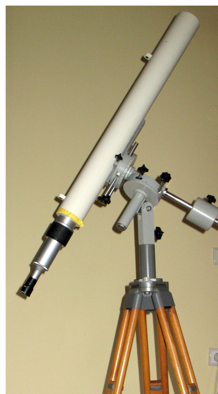
Luneta "Telemontor" firmy Zeiss. Średnica obiektywu 63 mm, ogniskowa 83 cm.
