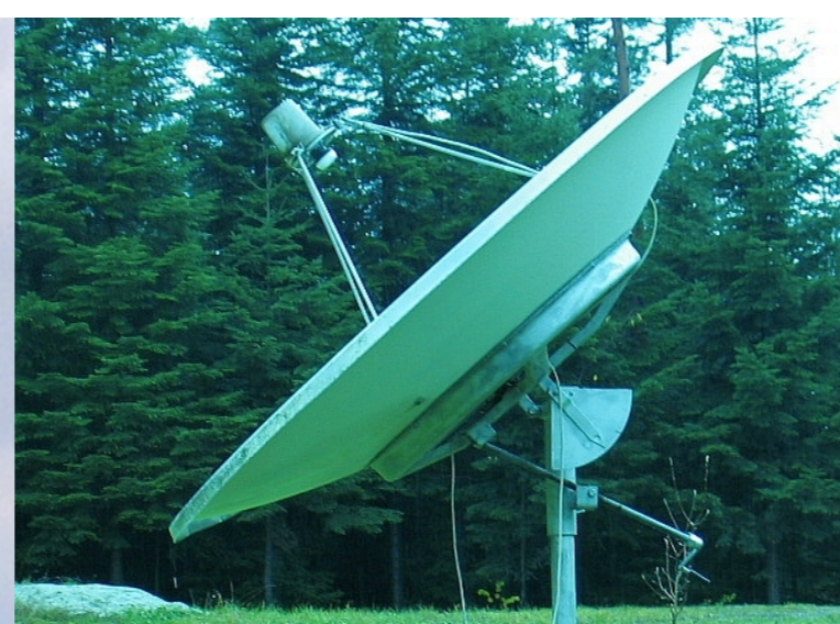
Dydaktyczna antena satelitarna do demonstracji odbioru sygnałów od satelitów geostacjonarnych i od Słońca. Średnica czaszy paraboloidalnej 1.8 m.
