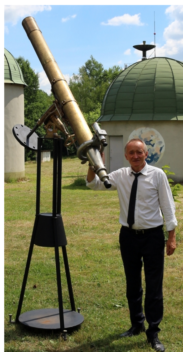
Luneta "Metlera", firmy Zeiss. Obiektyw o średnicy 11 cm. Ogniskowa 203 cm.
