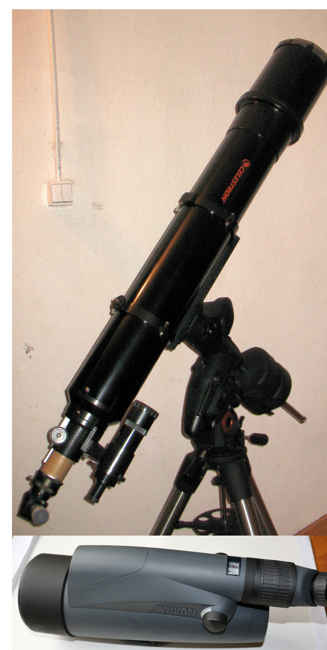
U góry luneta firmy Celestron o średnicy obiektywu 15 cm. Poniżej luneta o średnicy obiektywu 10 cm firmy Yukon.
