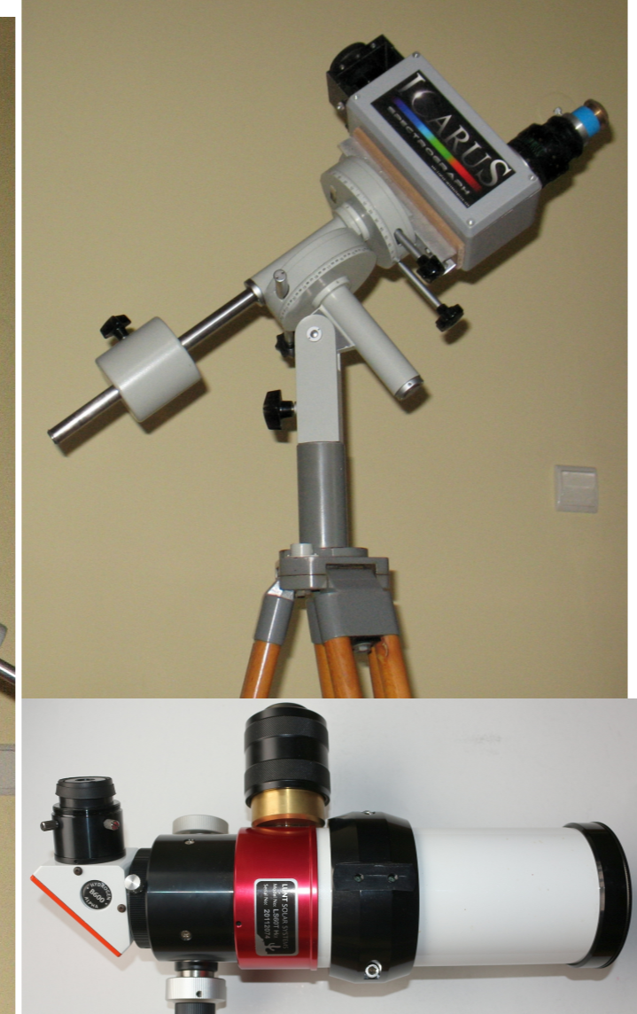
Spektrograf słoneczny (u góry) do obserwacji linii Fraunhofera. Zamieszczono widmo pochodzący z tego spektrografu. Poniżej teleskop słoneczny z filtrem H \alpha firmy LUNT.
