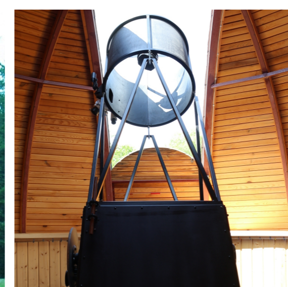
Teleskop zwierciadlany o średnicy obiektywu 50 cm. System optyczny Newtona.
