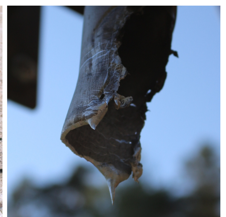
Po 25-ciu sekundach pracy, silnik się przetopił.
